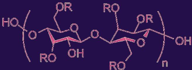
Fabricada a partir de celulosa alcalina que reacciona con óxido de propileno a temperatura y presión elevadas. Éter de celulosa en el que los grupos OH de la anhidroglucosa se sustituyen por grupos hidroxipropil.
